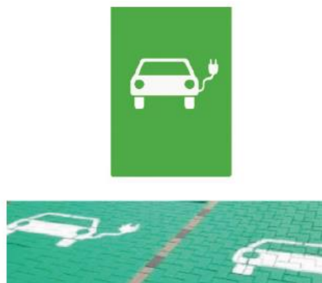
Abb. 91: Bodenmarkierung zur Kennzeichnung von öffentlichen und teilöffentlichen Ladeparkplätzen.
