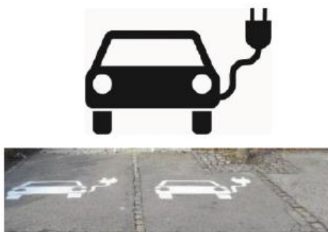
Abb. 91: Bodenmarkierung zur Kennzeichnung von öffentlichen und teilöffentlichen Ladeparkplätzen.
