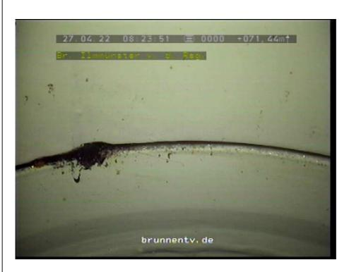
Foto : 21 Teufe : 71,44 m : 00:00:00 Video Kürzel : Filterrohr
