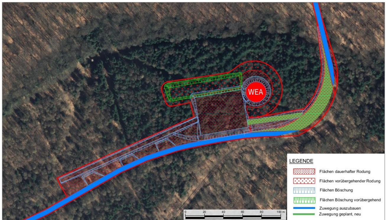
Abbildung 6: Planzeichnung der Flächeninanspruchnahme einer Windenergieanlage (WEA)
